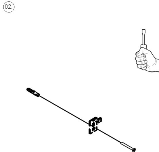
Bringen Sie die Aufhängehaken in die Dübel an und richten Sie diese mit einer Wasserwaage aus.
