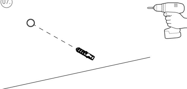
Bohren Sie das zuvor markierte 8 mm Loch für den Haltewinkel und stecken den Dübel ein.
