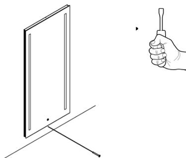
Befestigen Sie den Spiegel mittels des Haltewinkels an der Wand.
